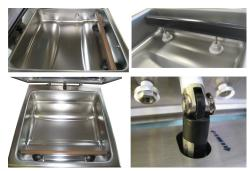
SEALING BAR 410mm VACUUM PUMP 20 m³/h ABSOLUTE SENSOR CONTROL
