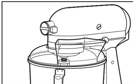
**1** Per un migliore risultato, far ruotare il coperchio in modo che la sua apertura a "u" sia coperta dalla testa del motore. Guardando il robot da cucina frontalmente, l'imboccatura di riempimento si trova a destra dell'attacco per accessori.
