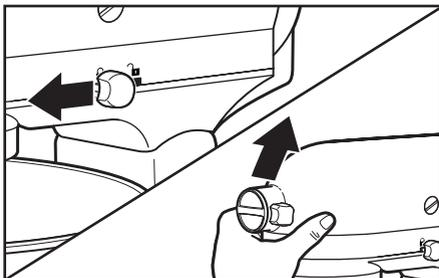
**1 So heben Sie den Motorkopf:** Drücken Sie den Verriegelungshebel in die geöffnete Stellung und heben Sie den Motorkopf an. Sobald der Kopf angehoben ist, kehrt der Hebel in die geschlossene Stellung zurück, sodass der Kopf angehoben bleibt.
