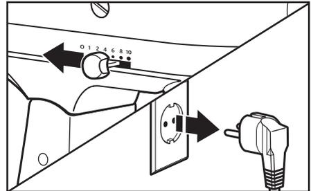
1 لتركيب الكبة: قومي بإزاحة مفتاح التحكم في السرعة إلى الوضع "O". ثم قومي بفصل قابس الخلاط الثابت عن مأخذ الكهرباء.
