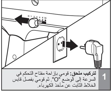
1 لتركيب ملحق: قومي بإزالة مفتاح التحكم في السرعة إلى الوضع "O". ثم قومي بفصل قابس الخلاط الثابت عن مأخذ الكهرباء.
