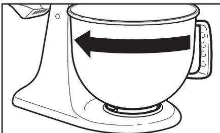
**3** Setzen Sie die Schüssel auf die Schüsselverriegelungsplatte. Drehen Sie die Schüssel vorsichtig im Uhrzeigersinn.
