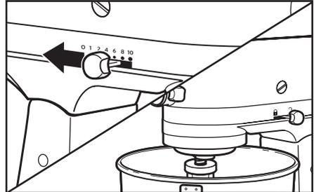
**1** لوضع درع الصب: قومي بإزاحة مفتاح التحكم في السرعة إلى الوضع "0". ثم قومي بفصل قابس الخلاط الثابت عن مأخذ الكهرباء. قومي بتركيب الملحق المرغوب فيه، راجعي قسم "تركيب/إزالة المضرب المسطح أو المخفقة ذات الأسلاك أو مضرب العجين".
