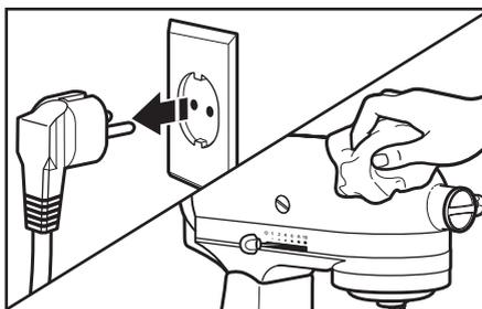
**1** Przed przystąpieniem do mycia miksera stojącego upewnić się, że jest on odłączony od sieci zasilającej. Wyrzeć mikser stojący wilgotną, ale nie moką, miękką ściereczką. Należy często wycierać wałek napędu ze sworzniem usuwając zbierające się w tym miejscu resztki produktów. Nie zanurzać miksera stojącego w wodzie i innych płynach.
