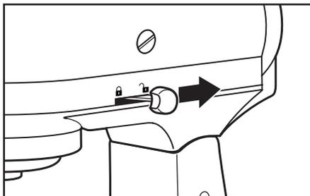
**2 So senken Sie den Motorkopf:** Drücken Sie den Verriegelungshebel in die geöffnete Stellung und senken Sie den Motorkopf vorsichtig ab. Der Verriegelungshebel kehrt nach dem Absenken des Kopfes automatisch in die geschlossene Stellung zurück. Prüfen Sie den Verschluss vor dem Mischen, indem Sie versuchen, den Motorkopf anzuheben.
