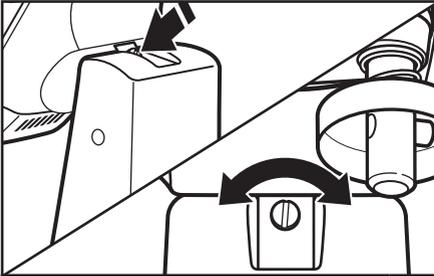
2 ارفعي رأس المحرك. أدير ي المسمار قليلاً عكس عقارب الساعة (يساراً) لرفع المضرب المسطح، أو في اتجاه عقارب الساعة (يميناً) لإنزال المضرب المسطح. قومي بضبط المضرب المسطح بحيث يمر عبر سطح الكبة تمامًا. إذا قمت بضبط المسمار بشكل زائد عن الحد، فقد لا يستقر ذراع قفل الكبة في مكانه.
