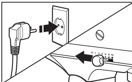
**1** Enchufe la batidora de pie a la toma de corriente eléctrica adecuada. Para comenzar, y a fin de evitar que los ingredientes salpiquen fuera del bol, sitúe la palanca de control de la velocidad en la velocidad más baja y, a continuación, aumente la velocidad gradualmente. Véase el siguiente cuadro.
