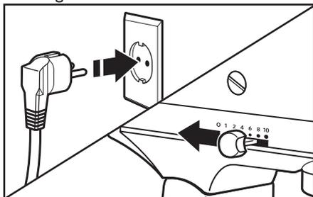
**1** Die Küchenmaschine an eine geeignete Steckdose anschließen. Wählen Sie zu Beginn stets die kleinste Geschwindigkeitsstufe und steigern Sie die Geschwindigkeit nur langsam, um ein Spritzen der Zutaten zu verhindern. Siehe folgende Tabelle.
