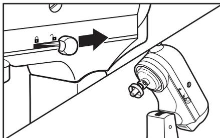
**2** Halten Sie den Verriegelungshebel in der geöffneten Stellung und kippen Sie den Motorkopf nach hinten.
