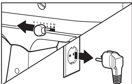
**3 Per rimuovere il coperchio versatore antispruzzo:** Posizionare la leva di regolazione della velocità su "0". Scollegare la presa del robot da cucina.
