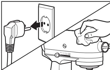
Se alltid till att köksmaskinens sladd är urdragen före rengöring. Torka av köksmaskinen med en mjuk, fuktig trasa. Använd inte rengöringsmedel avsedda för hushåll eller industri. Torka ofta av vispaxeln för att ta bort alla rester som kan ansamlas. Sänk inte ner köksmaskinen i vatten.
