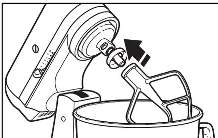
**3** Schieben Sie das Werkzeug in die Rührwelle und drücken Sie es so weit wie möglich nach oben. Drehen Sie es dann nach rechts, sodass es über den Stift an der Welle gleitet.
