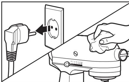
Husk altid at trække stikket ud af stikkontakten før rengøring. Aftør mixeren med en blød, fugtig klud. Brug ikke rengøringsmidler. Tør jævnligt piskerakslen af, og fjern eventuelle ophobede rester. Mixeren må ikke komme under/i vand.
