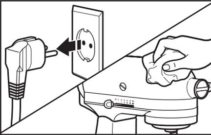
1 تأكدي دائمًا من فصل قابس الخلاط الثابت عن مأخذ الكهرباء قبل التنظيف. امسحي الخلاط الثابت باستخدام قطعة قماش ناعمة ورطبة. لا تستخدم المنظفات المخصصة للاستخدام المنزلي أو التجاري. قومي مسح عمود المضرب بشكل متكرر، مما سيساعدك على إزالة أية رواسب قد تتراكم. لا تغمره في الماء.
