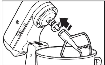
**3** Työnnä lisälaitte kiinnitysistukkaan ja työnnä ylöspäin niin pitkälle kuin mahdollista. Käännä sitten lisälaitetta oikealle, kiinnittäen lisälaitteen akselin tappiin.
