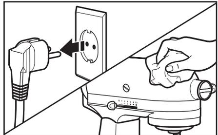
Immer den Netzstecker ziehen, ehe mit den Reinigungsarbeiten begonnen wird. Die Küchenmaschine mit einem feuchten weichen Tuch abwischen. Keine kommerziellen oder Haushaltreiniger verwenden. Die Rührerwelle regelmäßig abwischen und dort angesammelte Nahrungsmittelreste beseitigen. Nicht ins Wasser tauchen.
