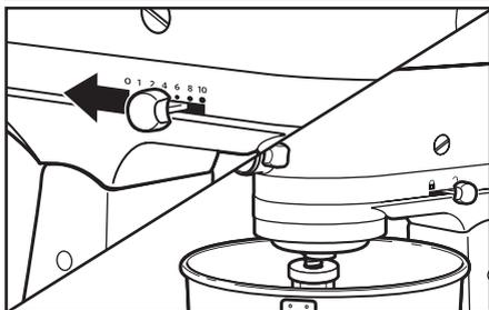
**1 Per installare il coperchio versatore antispruzzo:** Posizionare la leva di regolazione della velocità su "0". Scollegare la presa del robot da cucina. Collegare l'accessorio scelto; vedere la sezione "Collegamento/Rimozione della frusta piatta, della frusta a filo o del gancio impastatore".
