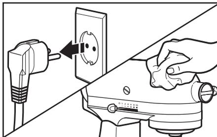
Tarkista aina, että yleiskone on irrotettu pistorasiasta ennen puhdistamista. Pyyhi yleiskone pehmeällä, kostealla liinalla. Älä käytä kotitalous-/kaupallisia puhdistusaineita. Pyyhi sekoittimen akseli säännöllisesti. Älä upota laitetta veteen.
