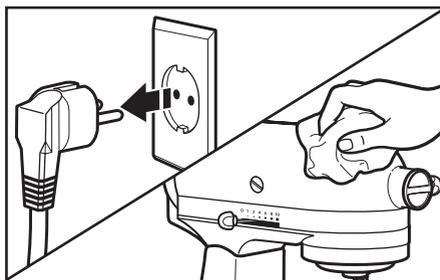
**I** Asegúrese siempre de desenchufar la batidora de pie antes de su limpieza. Limpie la batidora de pie con un trapo suave húmedo. No utilice productos de limpieza domésticos/comerciales. Limpie asiduamente con un paño el eje para el batidor, eliminando cualquier residuo que se pueda acumular. No la sumerja en agua.
