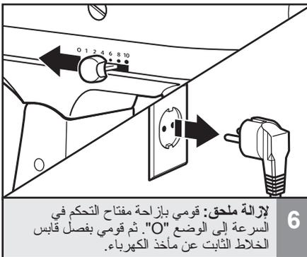
6 لإزالة ملحق: قومي بإزالة مفتاح التحكم في السرعة إلى الوضع "O". ثم قومي بفصل قابس الخلاط الثابت عن مأخذ الكهرباء.
