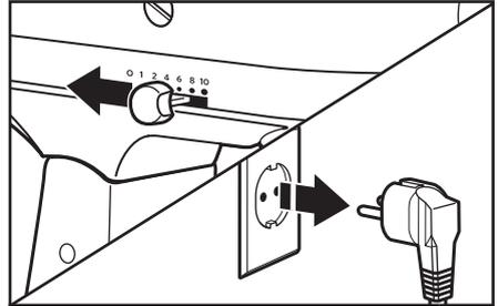
1 قومي بإزالة مفتاح التحكم في السرعة إلى الوضع "O". ثم قومي بفصل قابس الخلاط الثابت عن مأخذ الكهرباء.
