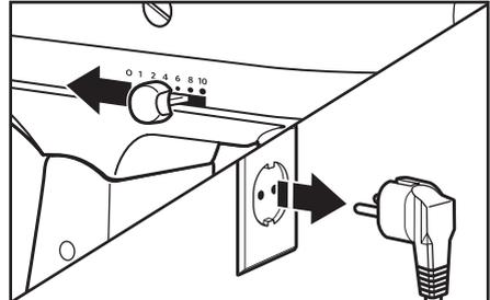
**3** لإزالة درع الصب: قومي بإزاحة مفتاح التحكم في السرعة إلى الوضع "0". ثم قومي بفصل قابس الخلاط الثابت عن مأخذ الكهرباء.
