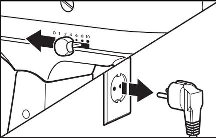
**1** لتركيب أحد الملحقات: قومي بإزاحة مفتاح التحكم في السرعة إلى الوضع "O". ثم قومي بفصل قابس الخلاط الثابت عن مأخذ الكهرباء.
