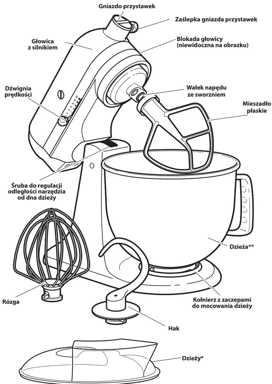
\*\* Konstrukcja oraz materiał wykonania dzieży zależy od modelu miksera planetarnego.
