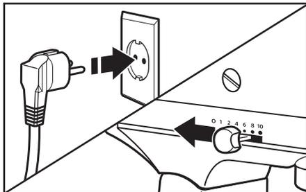
**1** Podłączyć mikser stojący do sieci elektrycznej. Podczas zaczynania pracy dźwignia kontroli prędkości powinna być zawsze ustawiona na najmniejszą wartość („0”), następnie można powoli zwiększać prędkość przesuwając ją w prawo. Więcej informacji w rozdziale „Prędkości miksera – wskazówki”.
