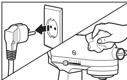
Assicurarsi sempre di staccare la spina del Robot da Cucina prima di pulirlo. Pulire il Robot da Cucina con un panno morbido inumidito. Non utilizzare detersivi per la casa/professionali. Pulire spesso l'albero impastatore, rimuovendo eventuali residui. Non immergerlo nell'acqua.
