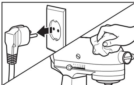
**I** Assurez-vous toujours de débrancher le robot sur socle avant de le nettoyer. Nettoyez le robot sur socle à l'aide d'un chiffon humide doux. N'utilisez pas de détergents. Essayez fréquemment l'axe à accessoire du robot pour enlever tout résidu de nourriture pouvant s'accumuler. N'immergez pas l'appareil dans l'eau.
